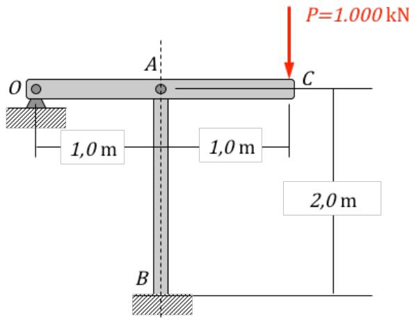
O esforço axial compressivo atuando na barra AB é  $N_{AB} = -2P$ . Portanto, para que não ocorra flambagem, e utilizando um coeficiente de segurança  $n = 4,0$ , devemos ter (onde  $L = 2\text{ m}$ ):
