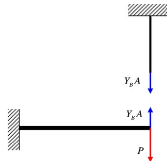
(c) Agora, como a viga tem um comportamento elástico/perfeitamente-plástico, o colapso plástico ocorre quando a barra está plastificada e a seção mais carregada da viga, a seção do engaste, também está plastificada
