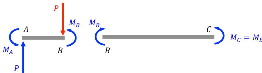
O Colapso plástico ocorre quando  $M_A = M_B = M_L$ . Portanto, como  $PL/3 = M_A + M_B$ , obtém-se:
