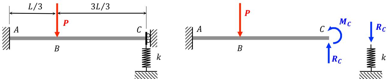
(a) Para  $k = 3EI/5L^3$ , determine a carga  $P_Y$  que leva ao início do escoamento na estrutura. (3,0 pontos).
