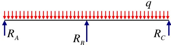
O momento fletor máximo ocorre na seção central da viga ( $x = L/2$ ):  $M_{\max} = M(L/2) = \frac{qL^2}{32}$
