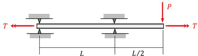
**Problema 3 (3,5 pontos).** Considere a barra de seção transversal circular, com diâmetro  $D$ , mostrada na figura abaixo. Na sua extremidade atua uma força de amplitude  $P$  na direção positiva do eixo  $z$ . Determine os estados de tensão nos pontos 1 e 2 da seção  $O$ , onde a barra está engastada.
