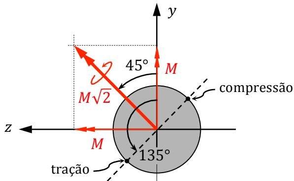
Para o momento fletor resultante na direção  $\theta = 45^\circ$ , a maior tensão normal trativa ocorre em  $\theta = 135^\circ$ , onde esta superpõe-se à tensão, também trativa, produzida pelo esforço normal. A tensão normal máxima, que portanto ocorre em  $\theta = 135^\circ$ , tem o valor:
