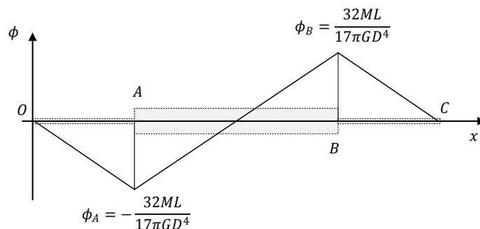
A máxima rotação, em valor absoluto, ocorre nas seções A e B. Observe que como o carregamento é antissimétrico, a rotação é nula no centro do eixo.
